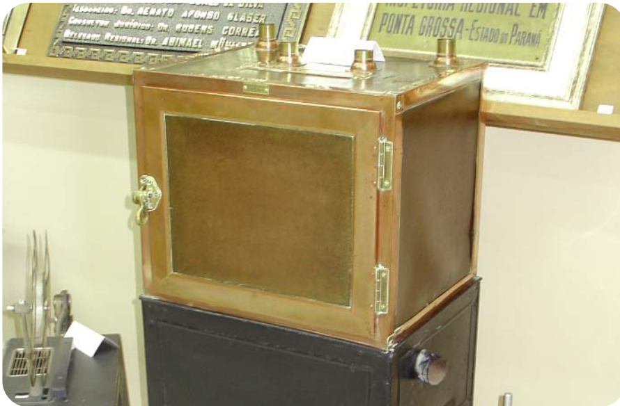
Estufa de laboratório de cobre e couro, movida a carvão, utilizada no final do século XIX.
